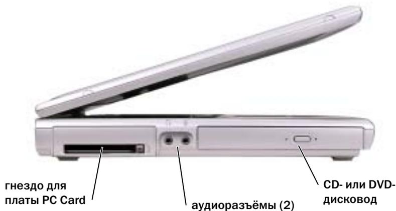
**Слот платы PC Card** — Поддерживает одну плату PC Card, например, модем или сетевой адаптер. Для получения дополнительной информации см. раздел «Использование плат PC Card» в файле *Справка Dell Latitude 100L*. Для доступа к файлу справки см. стр. 17.
