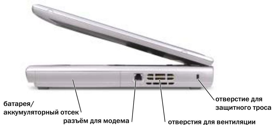
**Батарея/отсек для батареи** — После установки батареи вы можете пользоваться компьютером, не подключая компьютер к электрической розетке. См. стр. 37.
